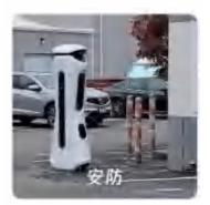
机器人代替人工进行巡检 工作,发现设备损坏异物 悬挂或外人出入等异常现 象,自动报警或进行预先 设置好的故障处理
